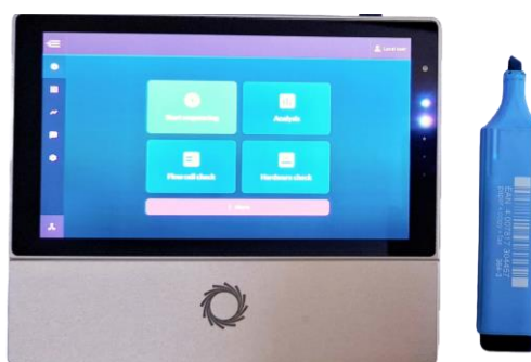
Figura 2: Vista comparativa del secuenciador MinION versión Mk1C (Oxford Nanopore Technologies) junto a un marcador indeleble que destaca la portabilidad de este dispositivo.
